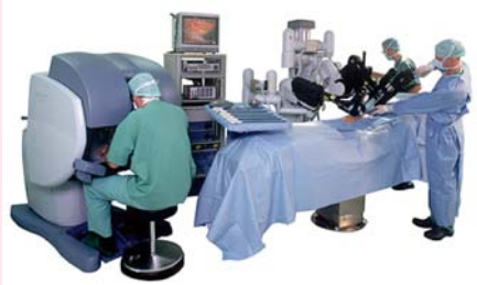
手術支援用ロボット「ダヴィンチ」の機器・操作イメージ
